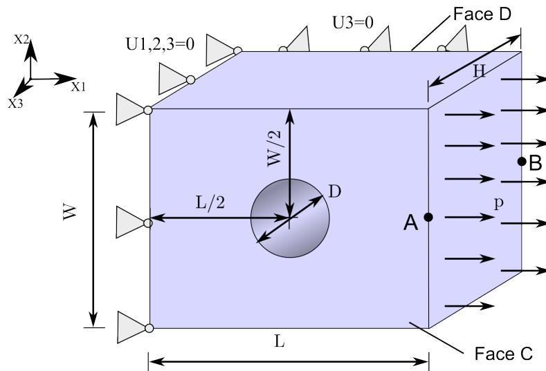
Comparez les déplacements  $U_1$  aux points A et B obtenus pour chaque formulation. Comparez qualitativement le champs des contraintes von Mises calculées sur les faces C et D. Discutez les résultats et essayez d'identifier des corrélations entre les modèles 2D et 3D.
